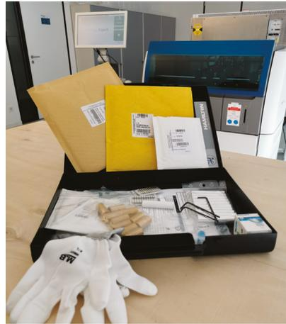
Des Weiteren befinden sich auch extra auf Ihr Gerät abgestimmte Werkzeuge sowie Zubehör in dem Koffer. Diese werden von Ihrem Techniker benötigt, um spezielle Einstellungen vorzunehmen oder das Gerät für eventuelle Transporte vorzubereiten.
